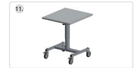
Pack- und Kommissionierwagen • Höhenverstellung durch Gasdruckzylinder • Tragfähigkeit max. 30 kg • Gewicht 52 kg
